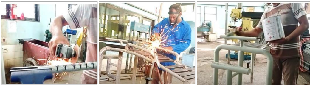
Gambar 9: Proses Pemotongan, Penyambungan dan Finishing
